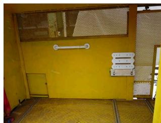
Im Inneren der Bahn gibt es eine Haltestange und einen Klappsitz für eine Begleitperson. Die Fenster sind aus Sicherheitsgründen mit Schutzgittern verkleidet.
